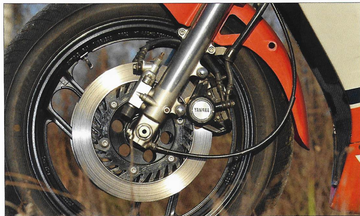
Ventilerade skivor, antidive, tvåkolvsok, 16 och 18 tumshjul, modernt 1984 men otänkbart på en sporthoj ett par år senare.
