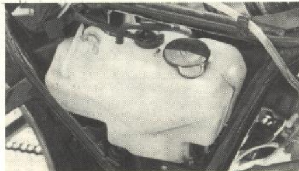
Oljepåfyllningen till separatsmörjningen sker bakom höger sidokåpa.
