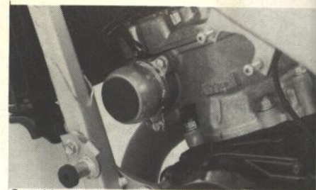
Suzukis ventil som öppnar den extra expansionskammaren. Servomotorn påverkar ventilen direkt.
