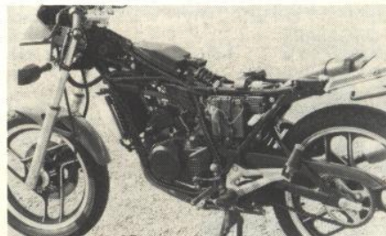
Yamahans ram av rundrör är stadig. Notera den enkla stötdämparen bakom luftrenaren.
