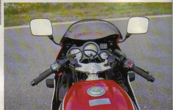
□ Backspeglar och blinkers förmår inte ta bort det rejsiga intrycket från RD 500:ans cockpit. Smalt clip on-styre, tävlingsmässigt funktionell instrumentering utan onödig flärd och ett kappglas som verkligen är gjort att krypa ned bakom och titta igenom...
