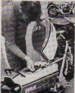
□ Tanken tas normalt sett inte bort, när man mekar med motorn, utan svängsupp i framkanten. Den hålls i upprätt läge av en särskild vajer, som finns med i verktygen.
