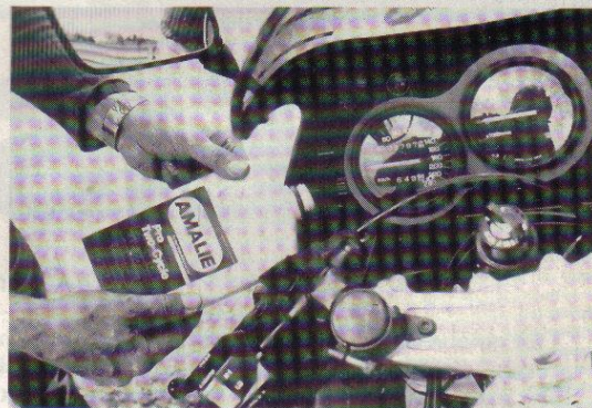
□ Oljetanken för separatoljesmörjningen sitter högt uppe, innanför kåpan. Påfyllningen är besvärlig, eftersom det är så lätt att spilla olja, som sedan rinner ned i kåporna.
